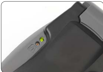
7. Luk låget på værktøjet og kontrollér at det grønne lys er tændt, ellers åbnes låget og konnektoren placeres rigtigt.
