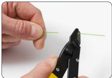
10. Strip fiberen min. 40 mm.
