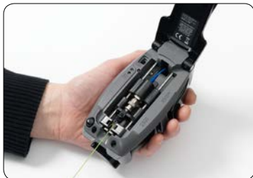
25. Nu aflastes fiberen ved at dreje håndtaget i bunden 180 grader.
