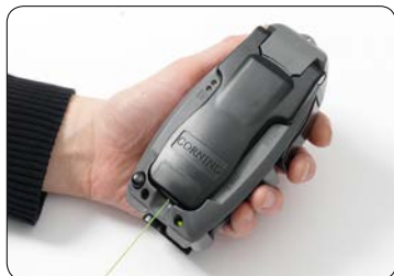
22. Cleav fiberen ved et tryk på den røde knap.
