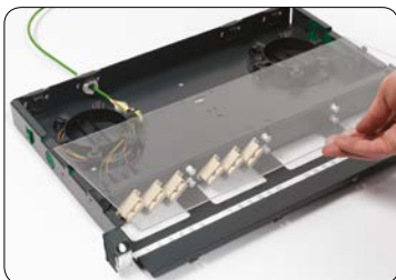
4. Konnektorerne sættes i adaptorerne. Sørg for at bøjningsradius stadigvæk overholdes alle steder.
