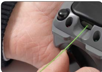
24. For at fjerne konnektoren, trykkes der på den øverste knap i højre side, hvorved slæden kører op.
