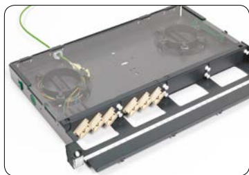
5. Sæt låget på fiberskuffen. Saml det overskydende kabel i én eller et par ringe og fastgør disse til skabets bagerste profil.
