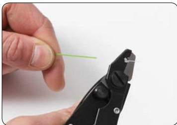
11. Sørg for at fiberen er rensset for al cladding ved at trække en ekstra gang med stripperen.
