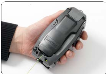
23. Hvis konnekteringen er udført korrekt lyser den grønne lampe.
