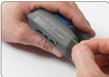
12. Kontrollér længden af den strippede fiber.
