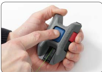
19. Fjern fiberen ved at holde den sorte knap inde mens den trækkes ud.
