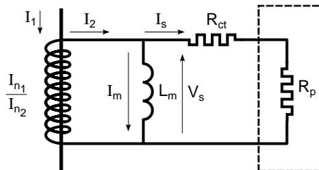
**Fig. 2** : a CT equivalent circuit.
